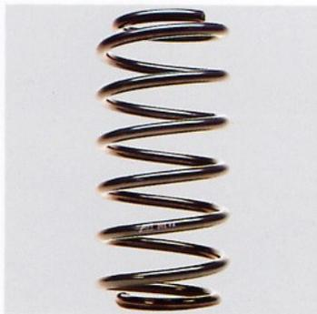
Abb. 5: Fahrwerksfeder
