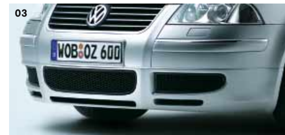
03 Die Frontschürze. Aus bruchsicherem Kunststoff hergestellt, betont sie das markante Erscheinungsbild des Passat. Sie ist sowohl für Ausführungen mit und ohne Nebelscheinwerfer erhältlich.
